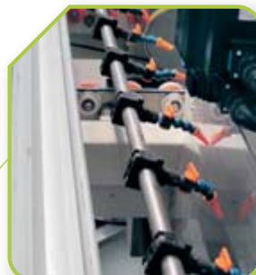
Lavaggio e asciugatura (soffiante) delle lastre in uscita. Cleaning and drying (blower) at glass exit side. Reinigung und Trocknung (Ventilator) der austretenden Glasscheibe. Limpeza y secado (soplador) de las hojas de vidrio en salida. Lavage et séchage (souffleur) des verres en sortie.
